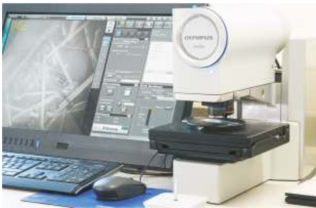
Glasfaser-Längenbestimmung mittels Oberflächenmikroskopie.
